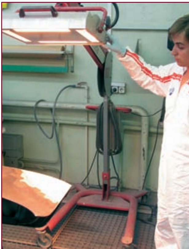
Использование ИК-сушки позволяет сократить время полимеризации до 2-3 минут.
