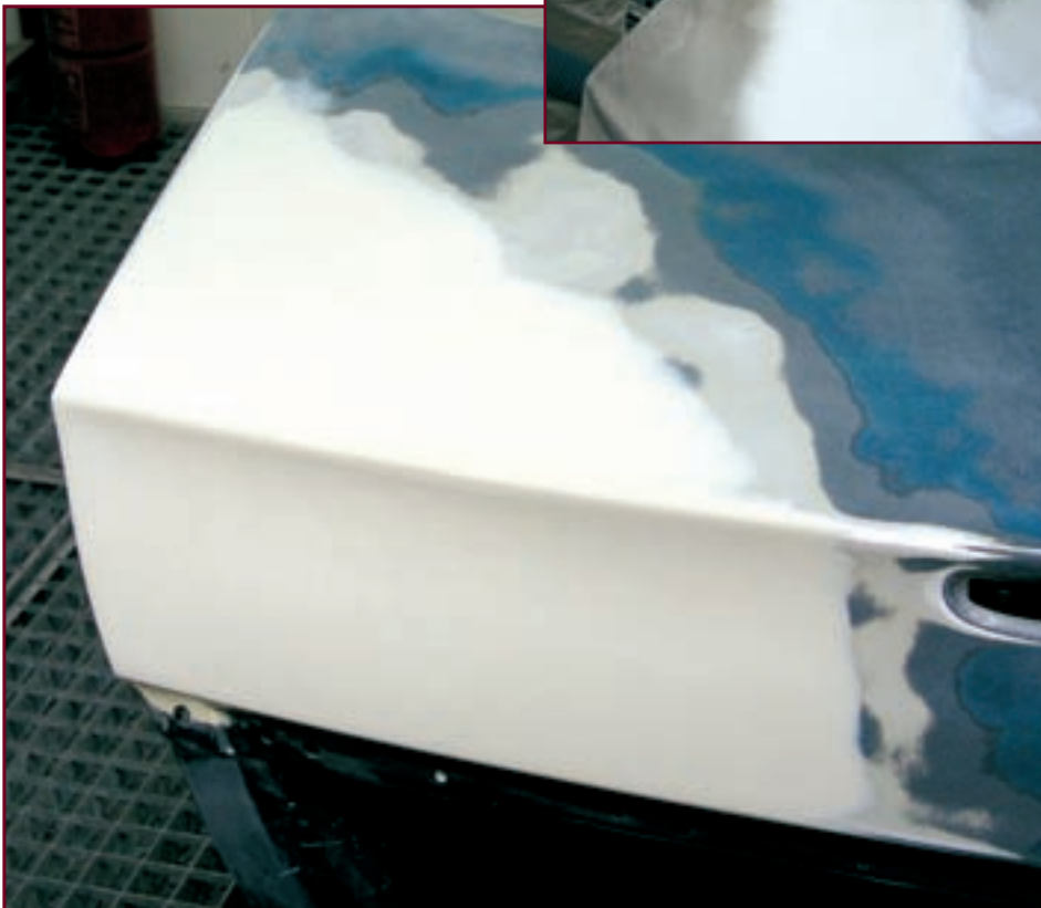
После сушки и шлифования DX86 получаем идеально подготовленную к грунтованию поверхность.
